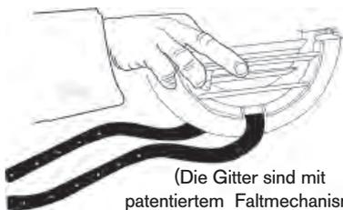
(Die Gitter sind mit patentiertem Faltmechanismus mittels Kette von Innen montierbar!)
